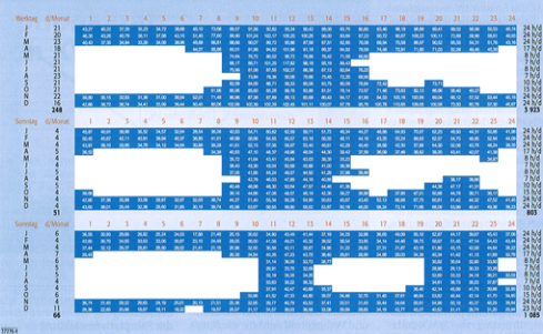
Bild 4. Einsatzplan einer außentemperaturgesteuerten KWK-Anlage
